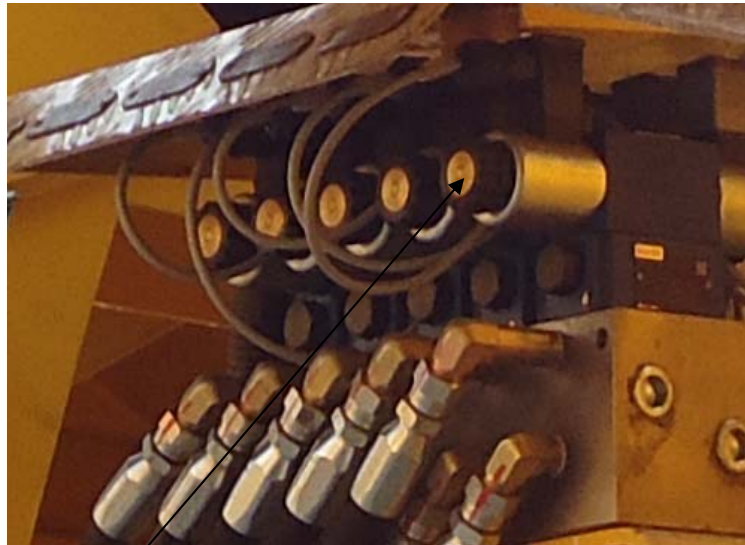
图 1 电磁换向阀应急按钮（两端）
